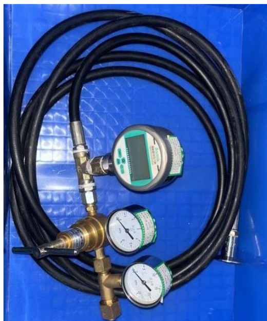
Abbildung 42 – Werkzeug zur Wartung des Kühlmitteldrucks
