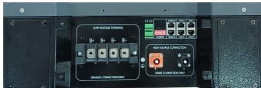
**NON MODIFICARE POSIZIONAMENTO DIPSWITCH CON BATTERIA ACCESA!!**
