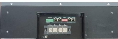
**NON MODIFICARE POSIZIONAMENTO DIPSWITCH CON BATTERIA ACCESA!!**
