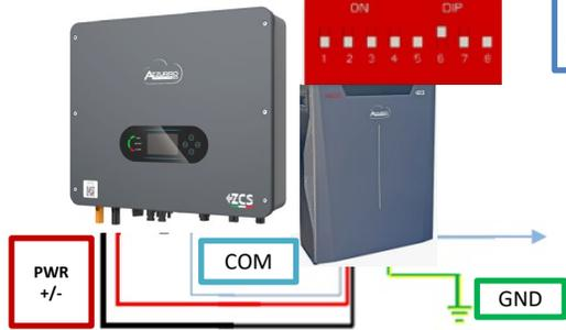
In caso di PIU' BATTERIE collegare il cavo di comunicazione dalla porta **COM** dell'inverter alla porta **CAN-A** della batteria MASTER , dopo aver definito il posizionamento corretto dei DIP Switch, (vedi pagina successiva).
