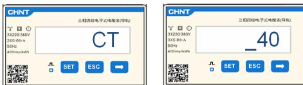
**Nota:** In caso di sonde CT diverse da quelle fornite in dotazione scrivere il corretto rapporto di trasformazione.
