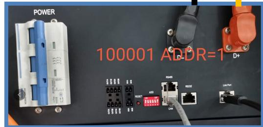
Ciascun BMS sarà connesso tramite cavi di potenza (+ e -) ai due ingressi dell'inverter, in particolare fare attenzione a collegare:
