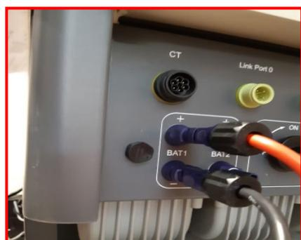
Estremità cavi di potenza con connettori da collegare al canale **BAT1** dell'**inverter**.
