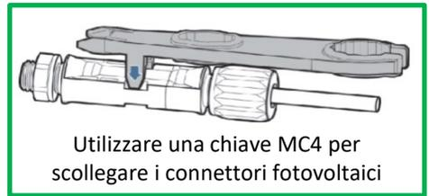
**ATTENZIONE** Prima di collegare/scollegare i pannelli PV all'inverter verificare che il sezionatore DC presente sull'inverter sia in posizione di OFF.
