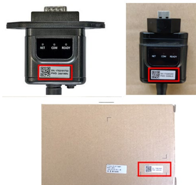
Figura 47 - Password dell'adattatore Wi-Fi esterno
