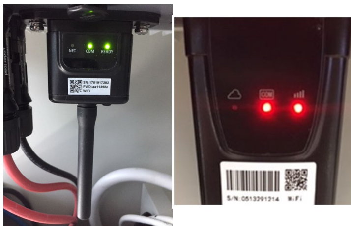
Figura 59 - Stato iniziale dei LED
