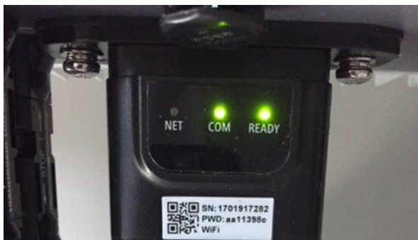
Figura 77 - Stato iniziale dei LED
