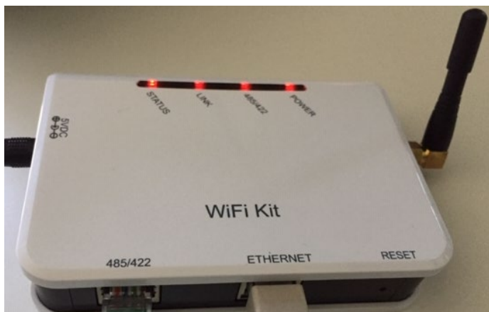
Figura 102 - LED che indica la corretta configurazione del datalogger
