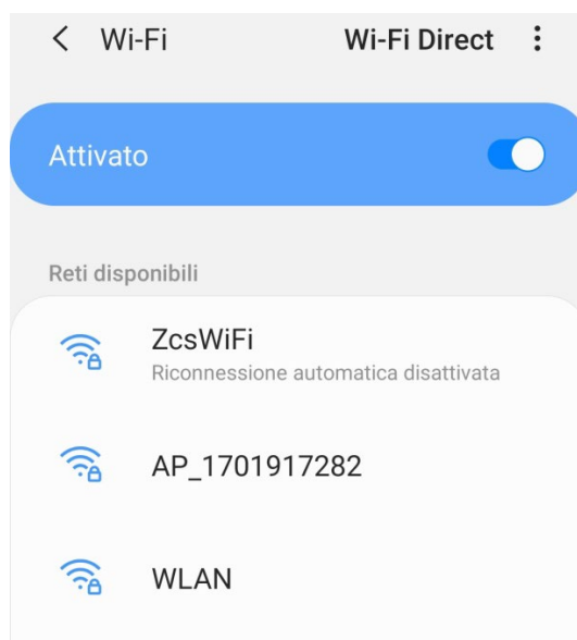
Figura 91 - Disattivazione della riconnessione automatica a una rete
