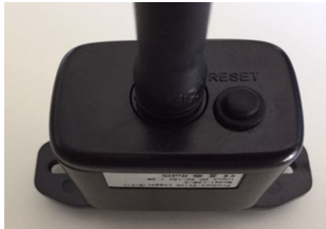
Figura 61 – Pulsante Reset sull'adattatore Wi-Fi
