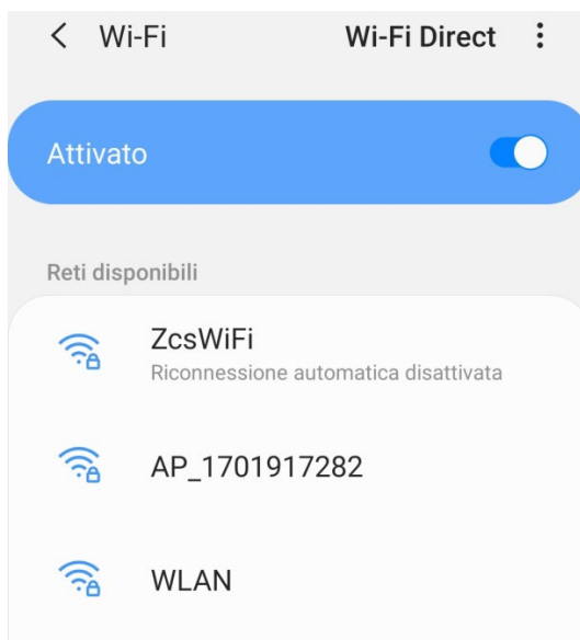
Figura 45 - Disattivazione della riconnessione automatica a una rete
