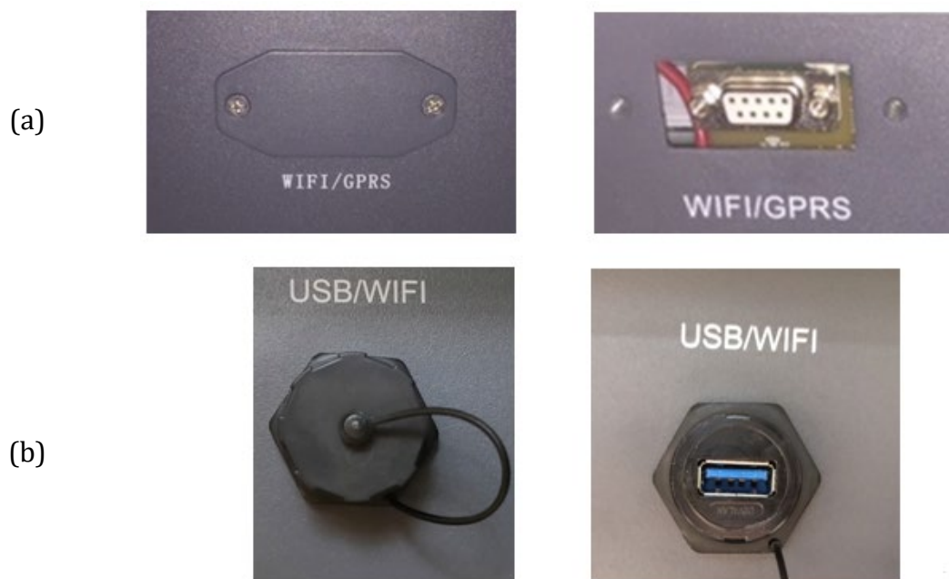
Figura 42 – Porta per adattatore Wi-Fi esterno
