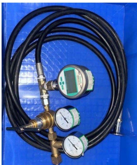
Figura 42 – Strumento di manutenzione della pressione del liquido refrigerante
