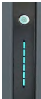
Figura 78- Pulsante di accensione della batteria AZZURRO 5000 PRO
