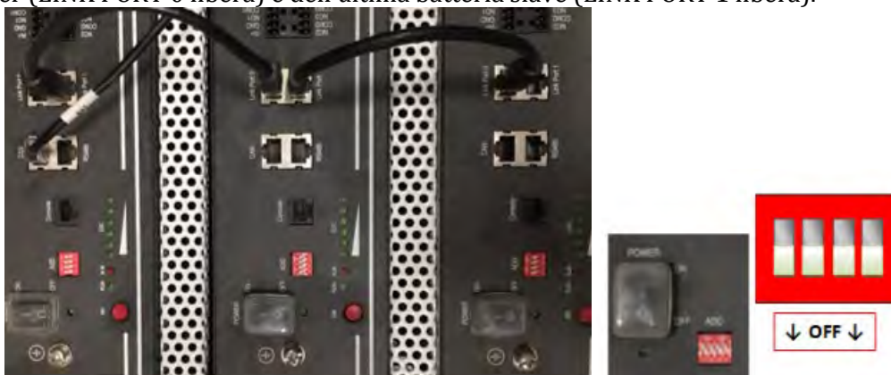
Figura 16 - Collegamento del cavo di comunicazione tra tre batterie Pylontech
