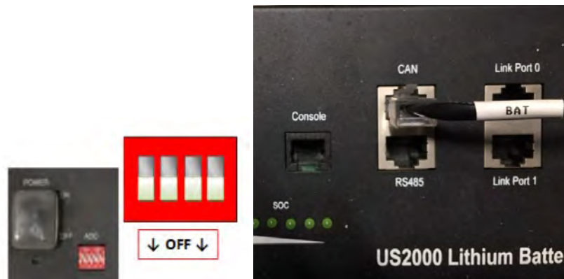
Figura 14- Collegamento del cavo di comunicazione alla batteria Pylontech
