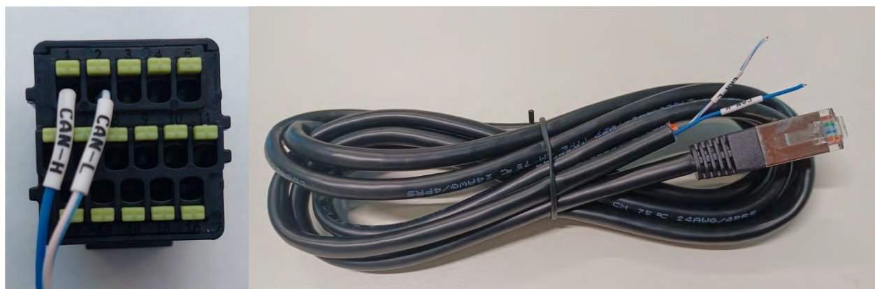
Figura 92 - Cavo di comunicazione tra l'inverter e la batteria AZZURRO 5000S
