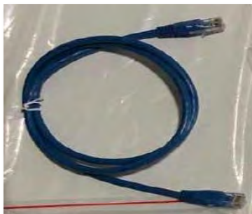
Figura 71 – Cavo di comunicazione tra batterie AZZURRO 5000
