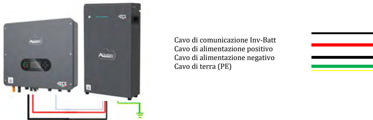
Figura 93 – Collegamento della batteria AZZURRO 5000S
