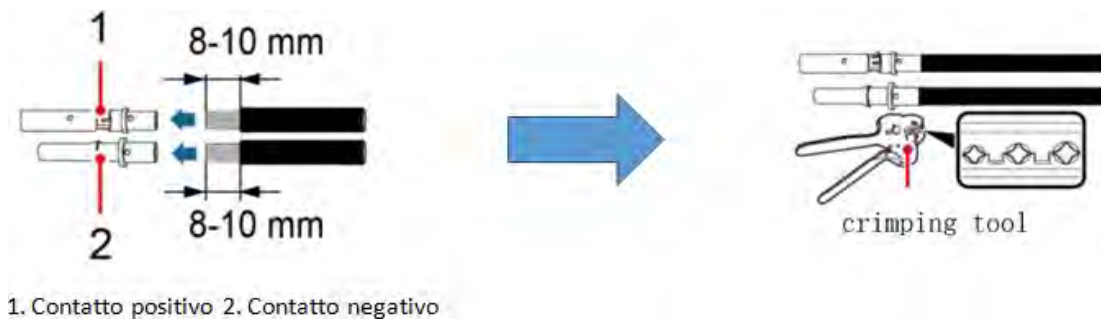
Figura 9 - Preparazione dei cavi fotovoltaici positivo e negativo
