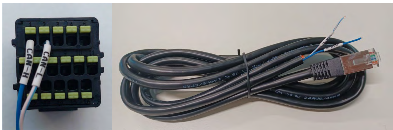
Figura 75 - Cavo di comunicazione tra l'inverter e la batteria AZZURRO 5000 PRO
