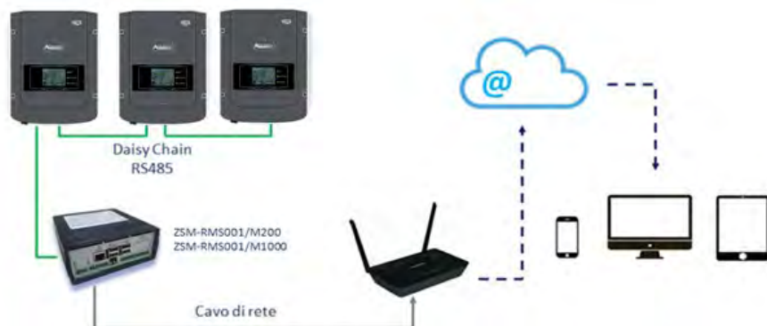
Figura 153 – Schema di funzionamento del datalogger ZSM-RMS001/M200 / ZSM-RMS001/M1000
