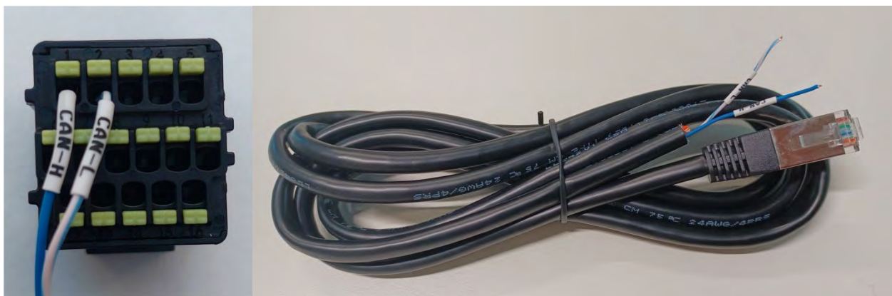
Figura 13 - Cavo di comunicazione Pylontech da inserire nell'ingresso di comunicazione della batteria
