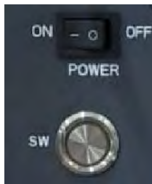
Figura 86- Pulsante di accensione della batteria AZZURRO ZSX 5120
