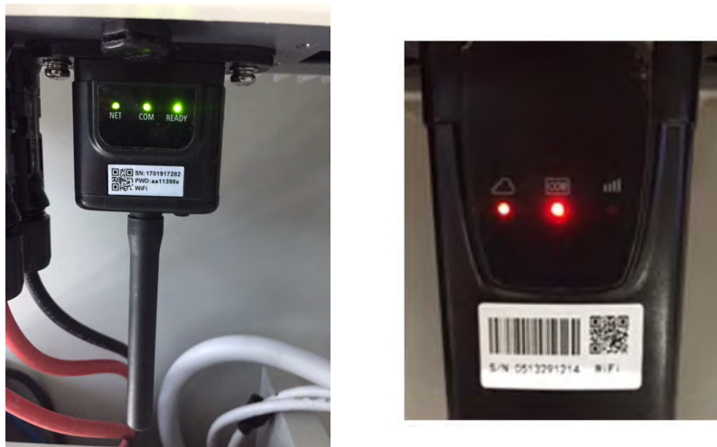
Figura 131 - Stato finale dei led
