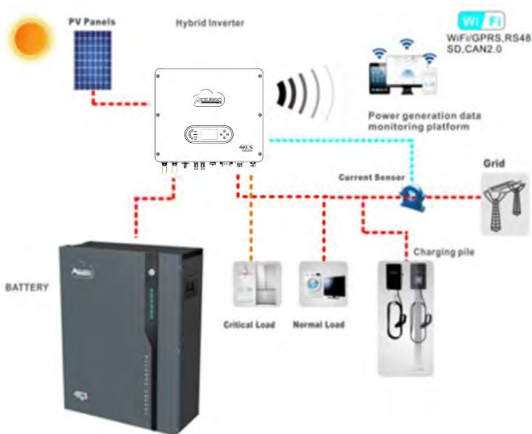
Figura 1 - Schema di un impianto su cui è installato un inverter ibrido 1PH HYD3000-HYD6000-ZSS-HP
