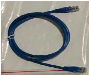
Figura 57 – Cavo di comunicazione tra batterie WeCo 5K3XP
