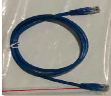
Figura 42 – Cavo di comunicazione tra batterie WeCo 4k4-LT
