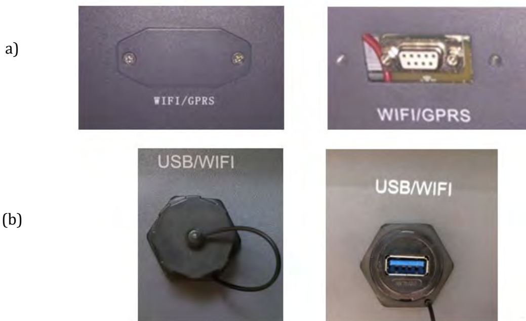
Figura 114 - Alloggiamento della scheda wifi esterna
