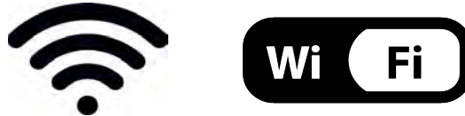
Figura 134 – Icone presenti sul display degli inverter monofase LITE (sinistra) e trifase o ibridi (destra)
