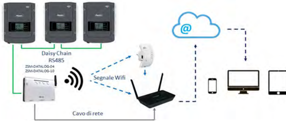
Figura 152 – Schema di connessione del datalogger ZSM-DATALOG-04 / ZSM-DATALOG-10
