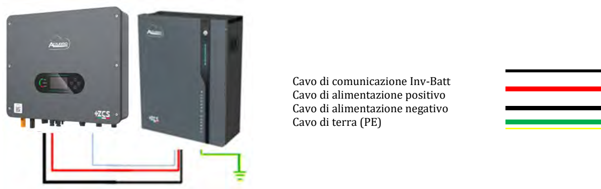
Figura 76 – Collegamento della batteria AZZURRO 5000 PRO
