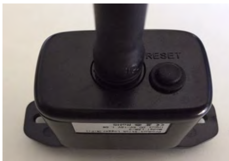
Figura 132 – Tasto di reset sulla scheda wifi
