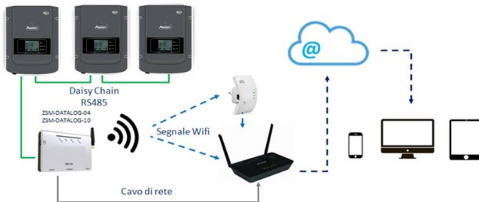
Figura 252 – Schema di connessione del datalogger ZSM-DATALOG-04 / ZSM-DATALOG-10
