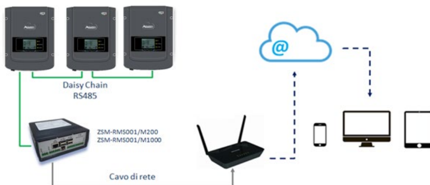
Figura 253 – Schema di funzionamento del datalogger ZSM-RMS001/M200 / ZSM-RMS001/M1000
