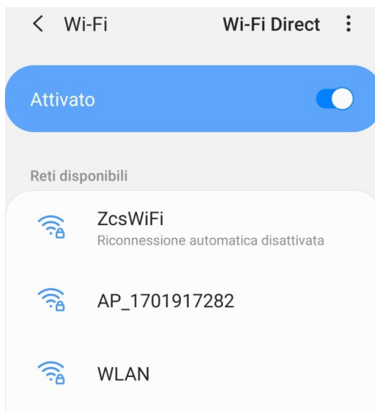
Figura 264 - Disattivazione della riconnessione automatica ad una rete
