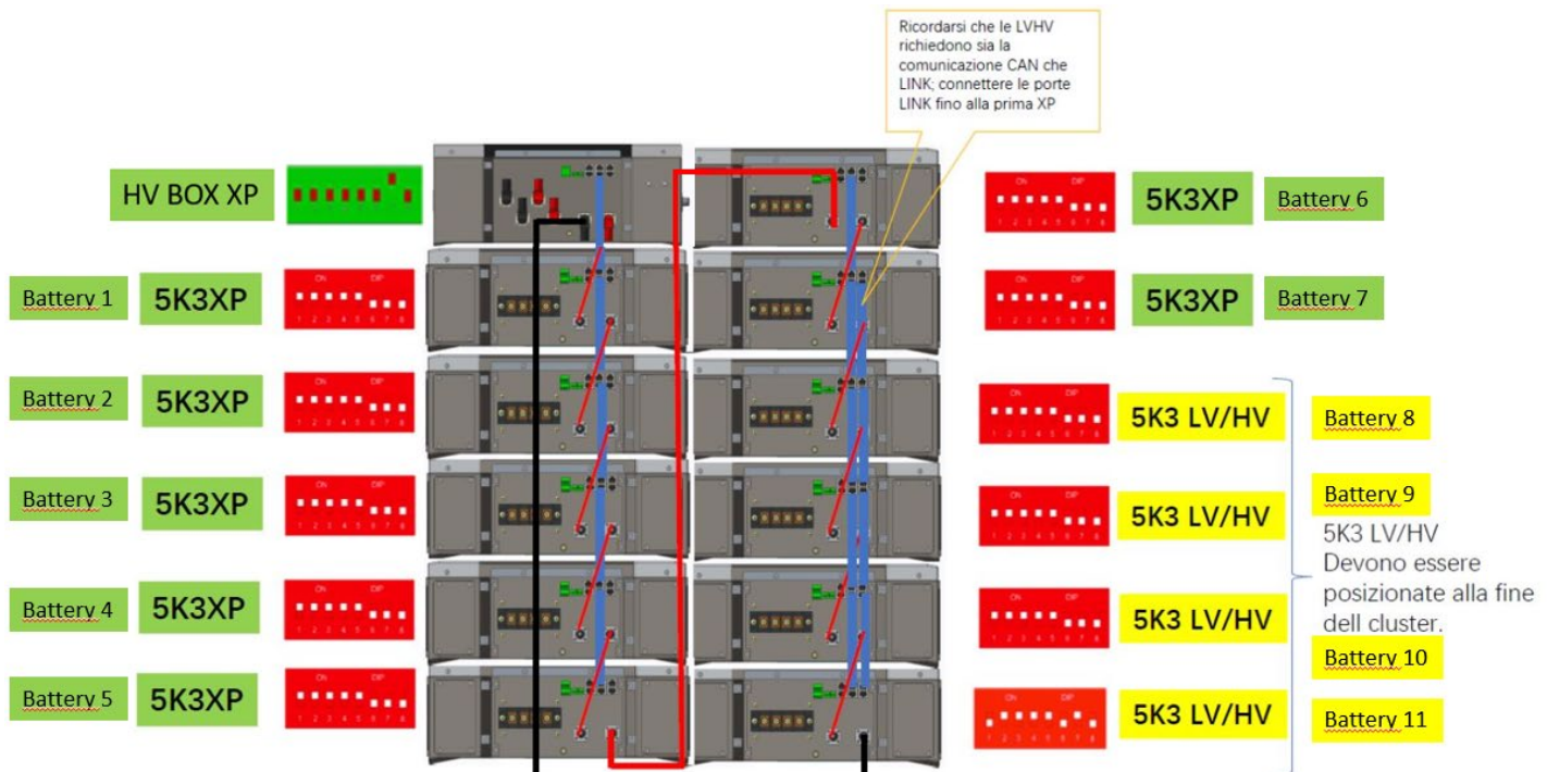
Figura 112 - Connessione potenza e comunicazione batterie 5K3 e 5K3XP
