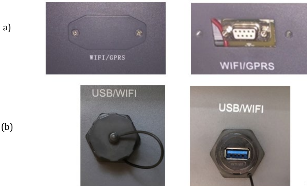
Figura 214 - Alloggiamento della scheda wifi esterna
