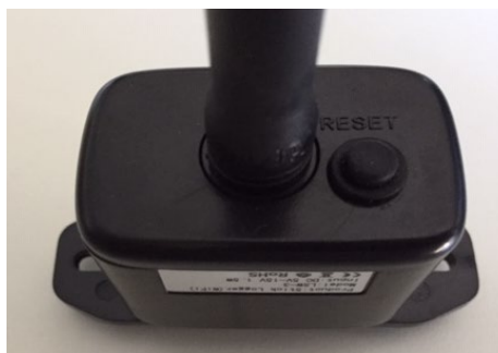
Figura 232 - Tasto di reset sulla scheda wifi
