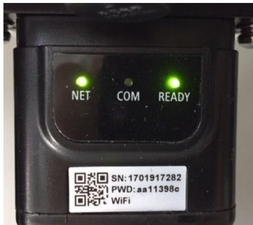
Figura 244 - Stato di comunicazione irregolare tra inverter e scheda
