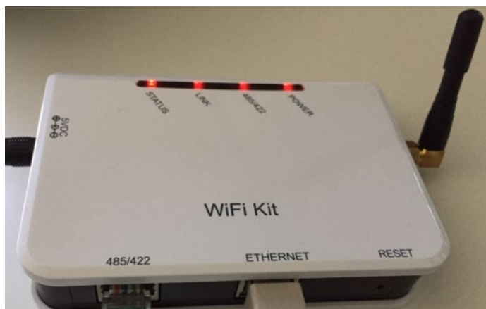
Figura 275 – Led che indicano la corretta configurazione del datalogger
