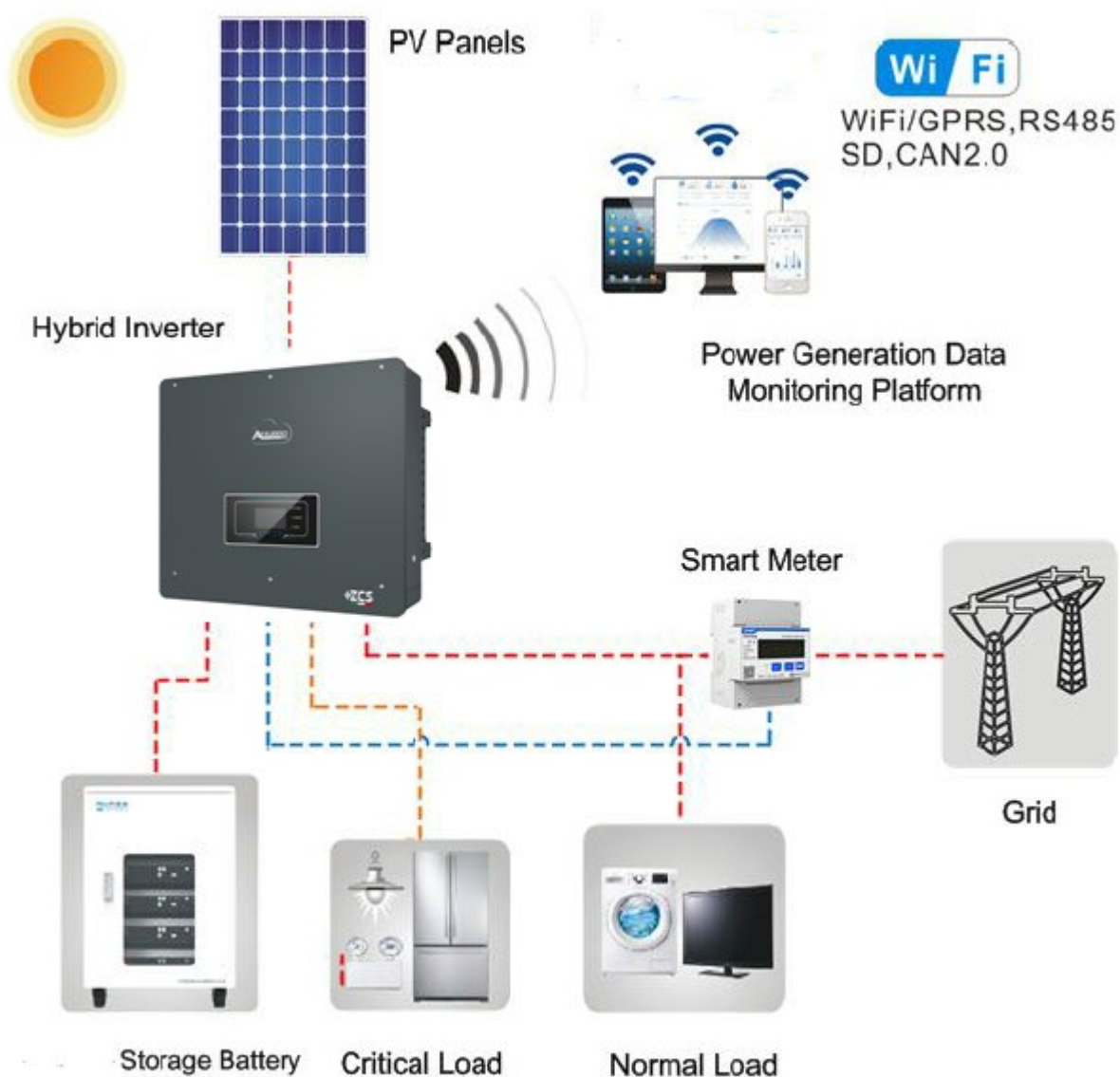
Figura 1 - Diagramma schematico di un impianto con inverter ibrido 3PH HYD5000-HYD20000-ZSS
