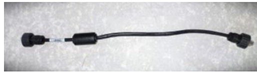
Figura 172 – Cavo di comunicazione tra BDU Smart 5K 1 e BDU Smart 5K 2
