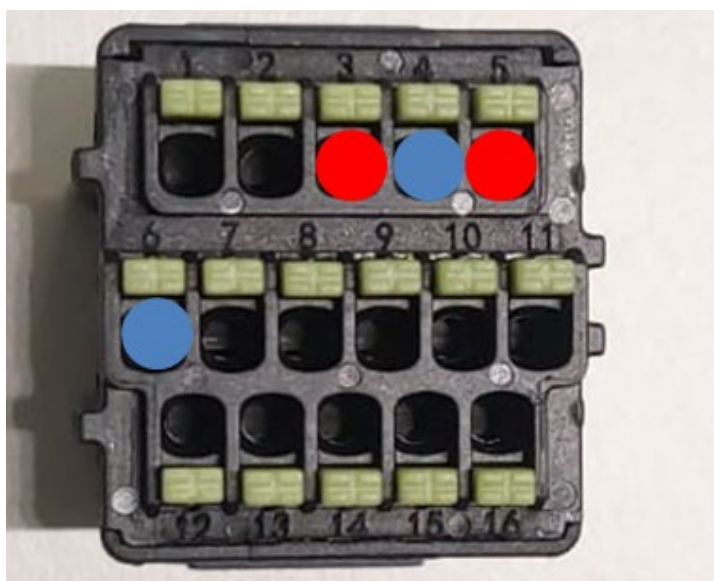
Figura 259 - Collegamento della linea seriale tramite connettore di comunicazione per 3PH HYD5000-HYD20000-ZSS
