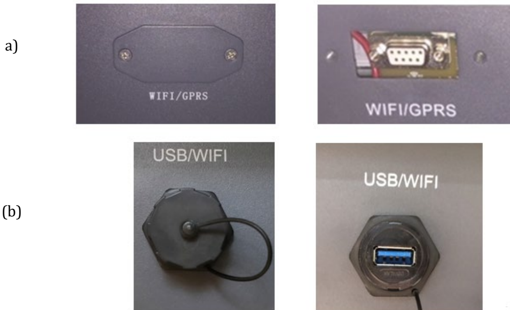
Figura 214 - Alloggiamento della scheda wifi esterna
