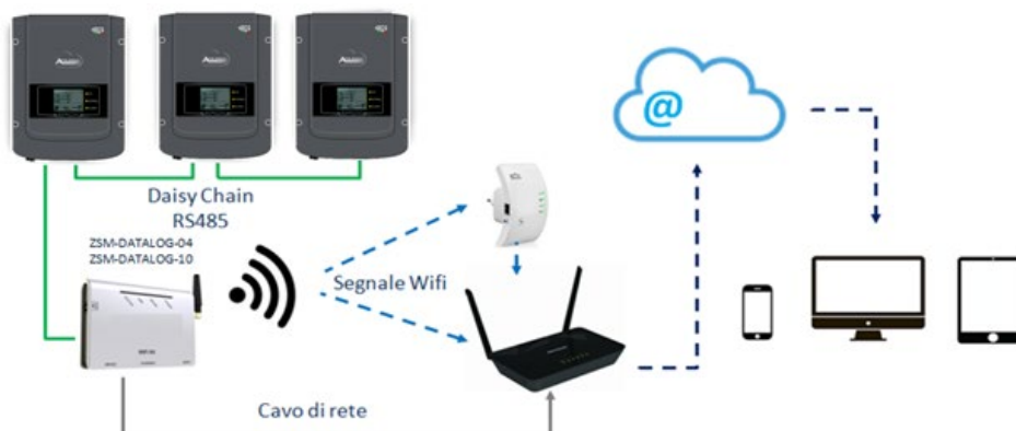
Figura 252 – Schema di connessione del datalogger ZSM-DATALOG-04 / ZSM-DATALOG-10
