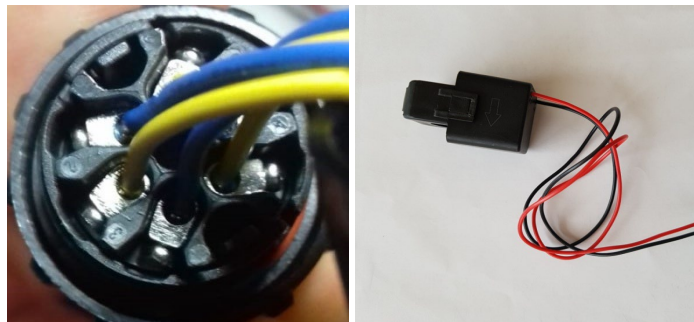
Figura 190 - Collegamenti numerati connettore CT
