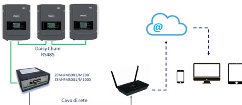
Figura 253 – Schema di funzionamento del datalogger ZSM-RMS001/M200 / ZSM-RMS001/M1000
