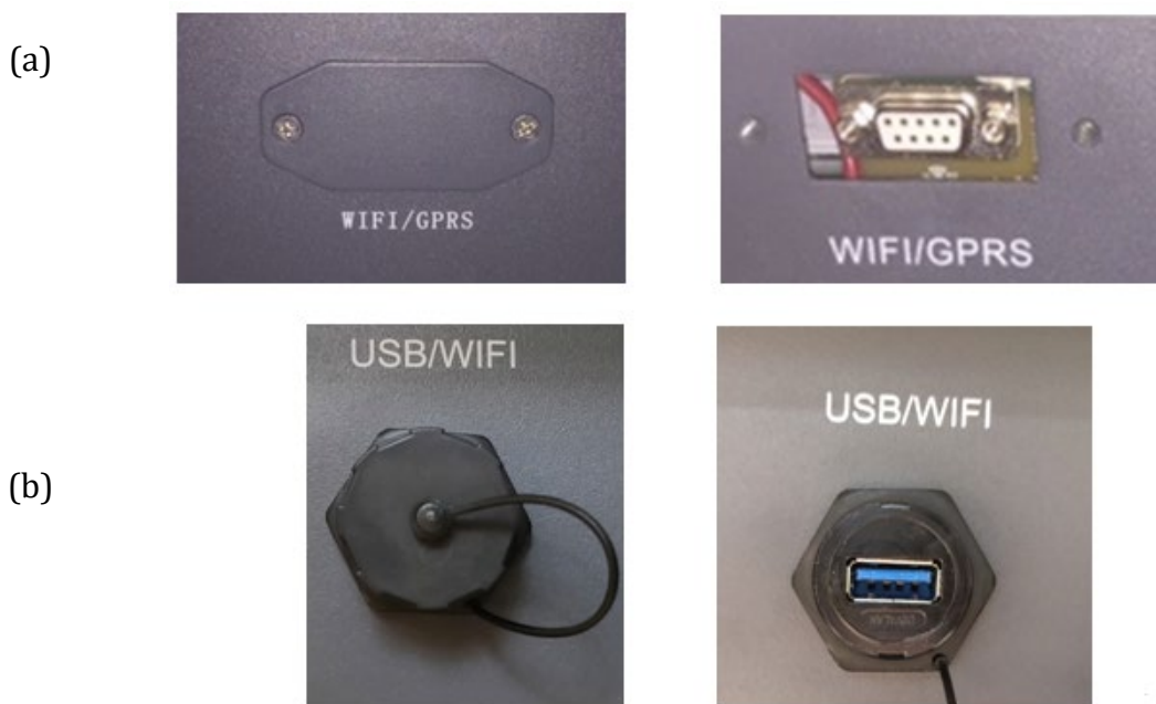
Figura 246 - Alloggiamento della scheda 4G
