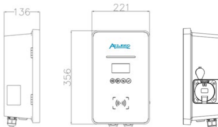
Figura 4 - Vista frontale, laterale della stazione di ricarica
