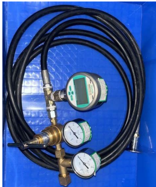
Figure 42 – Équipement de maintien de la pression du liquide réfrigérant
