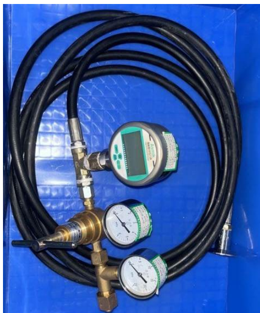
Rysunek 42 - Przyrząd do konserwacji ciśnienia płynu chłodzącego
