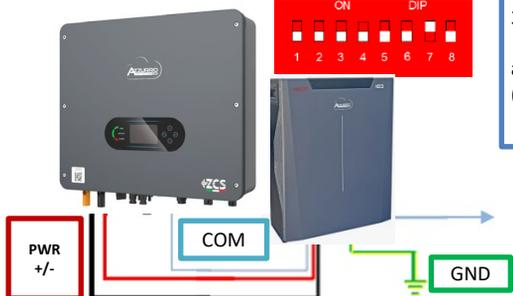
Im Fall von MEHREREN BATTERIEN das vom **COM**-Port des Inverters kommende Kommunikationskabel am Port **CAN-A** der MASTER-Batterie anschließen, nachdem vorher die korrekte Stellung der DIP-Schalter festgelegt wurde (siehe nächste Seite).
