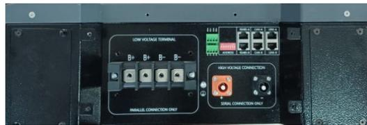
**DIE STELLUNG DER DIP-SCHALTER NICHT BEI EINGESCHALTETER BATTERIE ÄNDERN!!**
