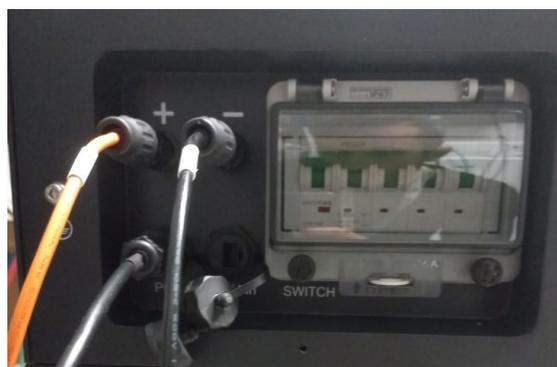
2. Presione el interruptor metálico START (aproximadamente 3 ~ 6s) de la BDU Smart 5K para encenderla, las luces led se encienden una tras otra;
