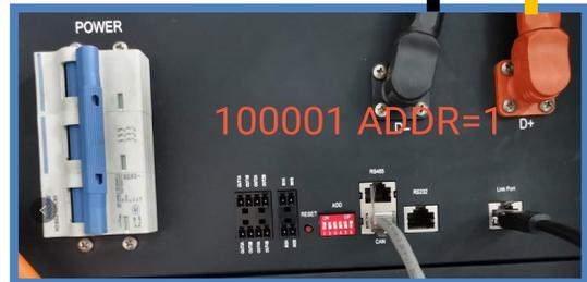
Cada BMS se conectará mediante cables de potencia (+ y -) a las dos entradas del inversor, preste particular atención a conectar:
