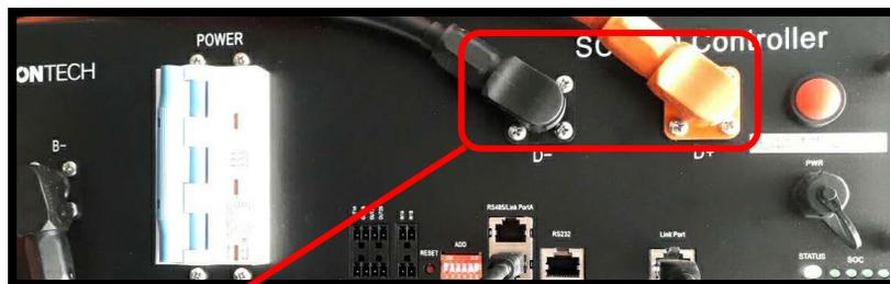
Extremos de los cables con conectores rápidos para conectar al BMS
