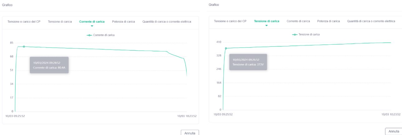
Abbildung 30: Ladegraphik zu Stromstärke und Batteriespannung.
