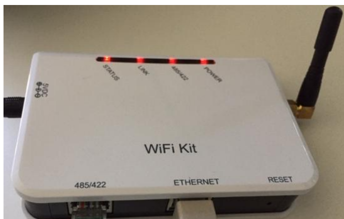
Рис. 99– Світлодіоди, які вказують на правильну конфігурацію реєстратора даних
