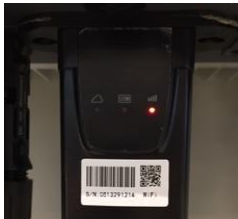
Рисунок 61 - Нестабільний стан зв'язку між Wi-Fi та віддаленим сервером
