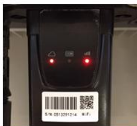
Рисунок 59 - Нестабільний стан зв'язку між інвертором та Wi-Fi
