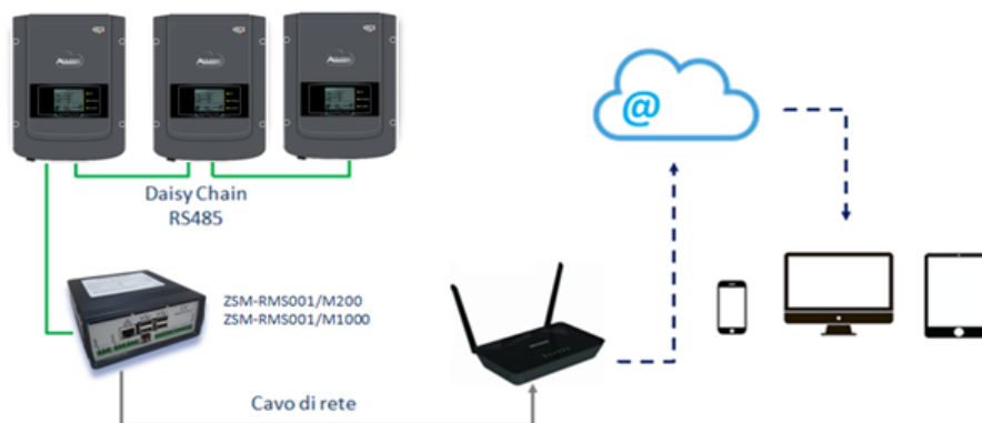
Рисунок 79 - Схема функціонування реєстратора даних ZSM-RMS001 / M200 / ZSM-RMS001 / M1000
