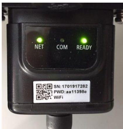
Рисунок 59 - Нестабільний стан зв'язку між інвертором та Wi-Fi
