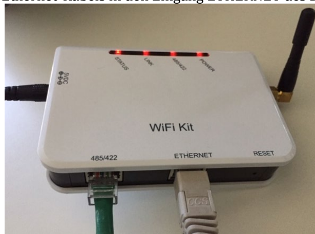
Abbildung 163 – An den Datenlogger angeschlossenes Ethernet-Kabel
