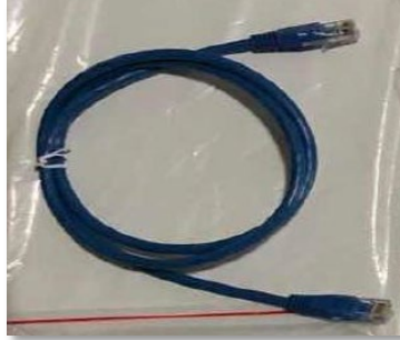
Abbildung 26 – Kommunikationskabel zwischen Batterien WeCo 4K4
