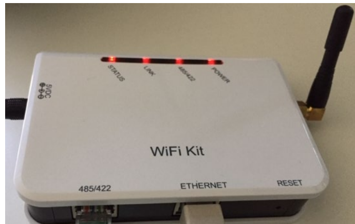
Abbildung 176 – Led, welche die korrekte Konfiguration des Datenloggers anzeigen
