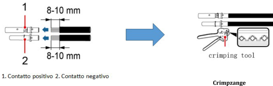
Abbildung 9 - Vorbereitung der positiven und negativen Solaranlagenkabel
