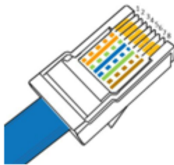
Abbildung 155 – Pinbelegung für die Verbindung des Steckers RJ45
