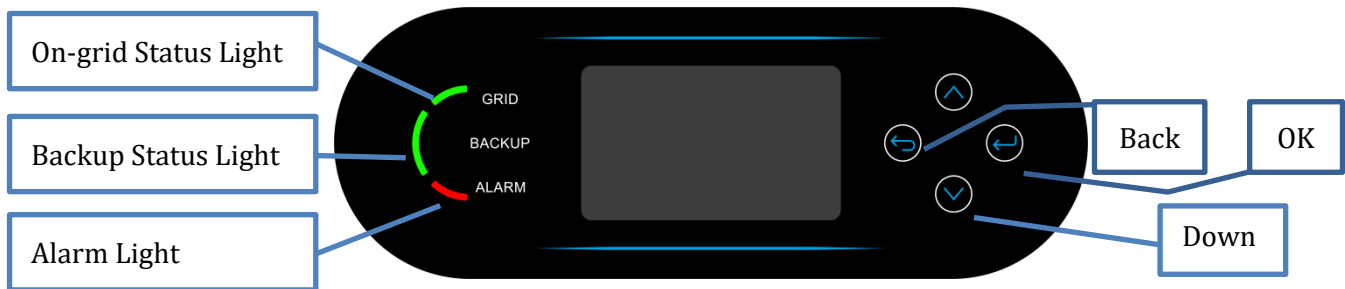
Abbildung 109 – Schaltflächen und Leuchtanzeigen
