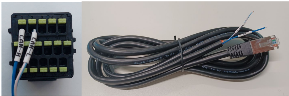
Abbildung 83 - Kommunikationskabel zwischen dem Inverter und der Batterie AZZURRO ZSX 5120
