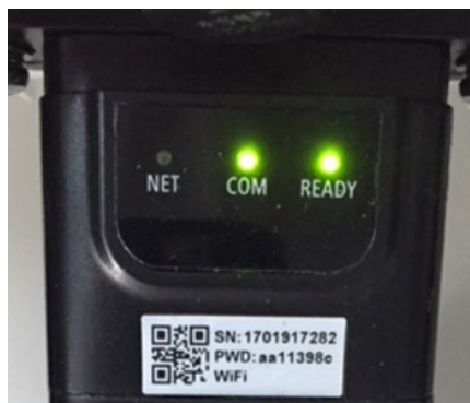
Abbildung 152 – Unregelmäßiger Kommunikationsstatus zwischen Platine und Remote-Server
