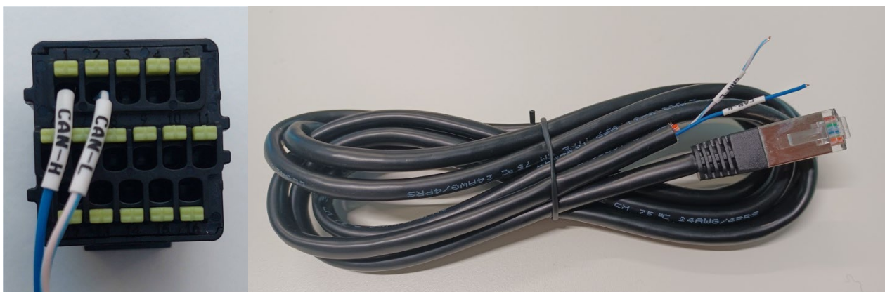
Abbildung 13 - Pylontech-Kommunikationskabel, das in den Kommunikationseingang der Batterie einzustecken ist
