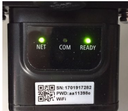
Abbildung 151 - Unregelmäßiger Kommunikationsstatus zwischen Inverter und Platine
