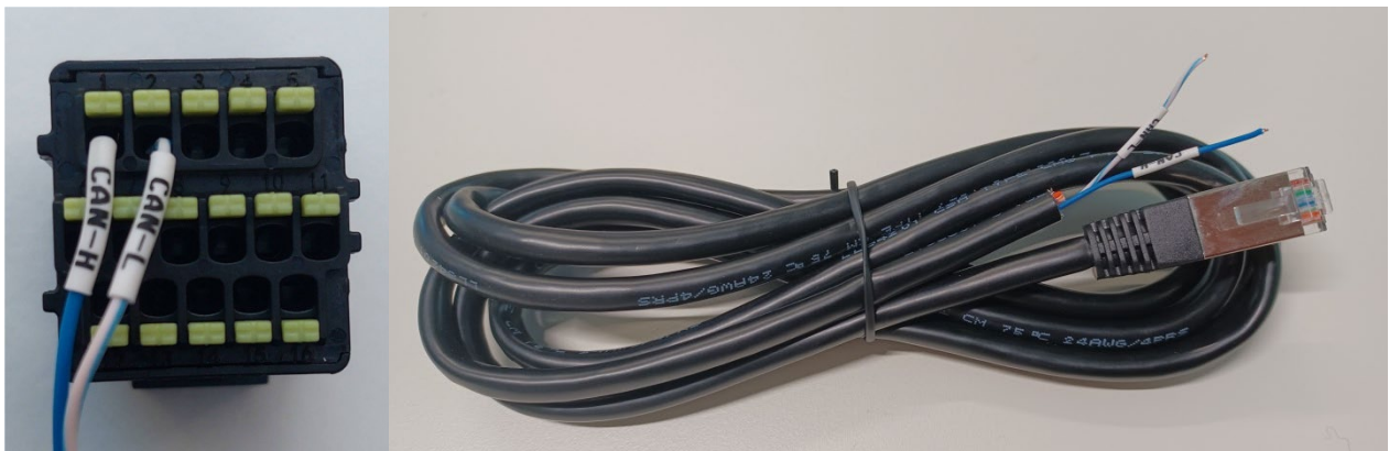
Abbildung 18 - Pylontech-Kommunikationskabel, das in den Kommunikationseingang der Batterie einzustecken ist
