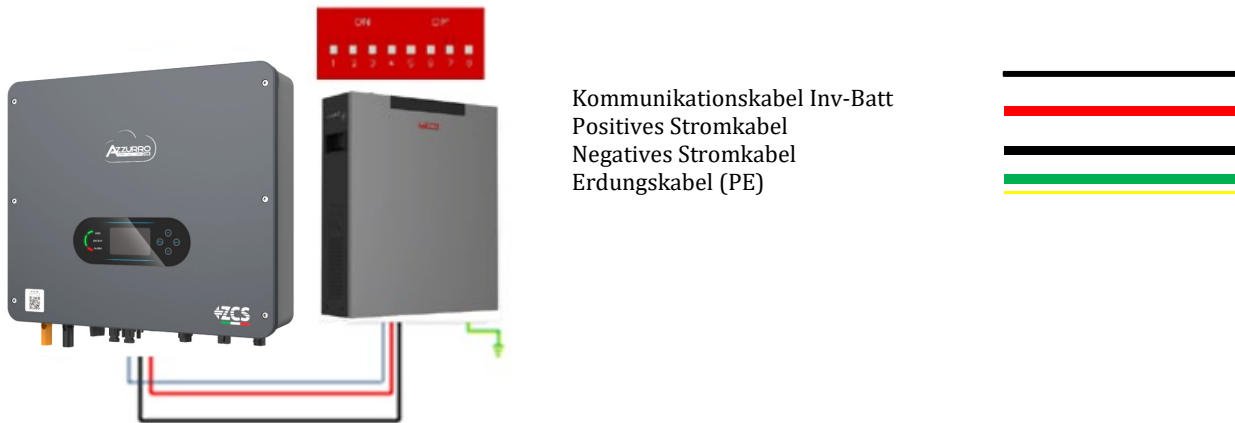
Abbildung 40 – Anschluss der WeCo Batterie 4K4-LT
