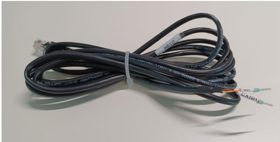
Abbildung 48 - Kommunikationskabel zwischen dem Inverter und der WeCo-Batterie 5k3
