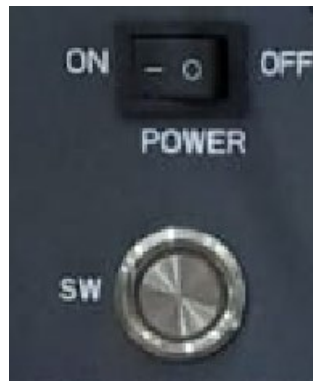
Abbildung 86 – Einschalttaste der Batterie AZZURRO ZSX 5120
