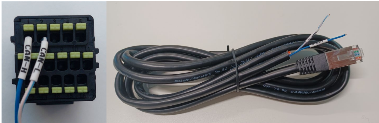
Abbildung 92 - Kommunikationskabel zwischen dem Inverter und der Batterie AZZURRO 5000 PRO
