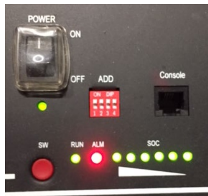
Abbildung 112 - Status der Batterie, nachdem der Schalter POWER auf ON geschaltet und die SW-Taste gedrückt wurde
