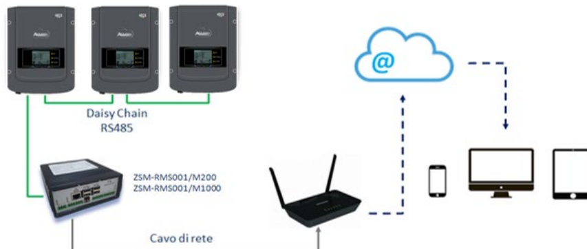
Abbildung 154 – Funktionsschema des Datenloggers ZSM-RMS001/ M200 / ZSM-RMS001/M1000
