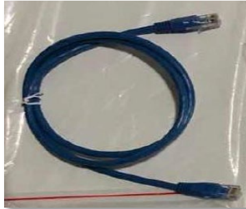
Abbildung 57 – Kommunikationskabel zwischen-Batterien WeCo 5K3XP
