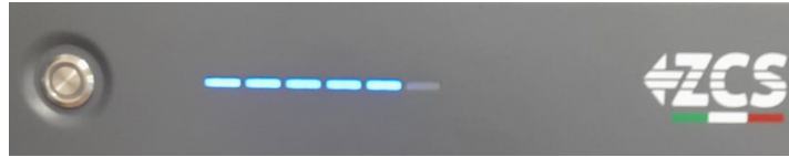
Abbildung 95 - Einschalttaste der Batterie AZZURRO 5000 PRO
