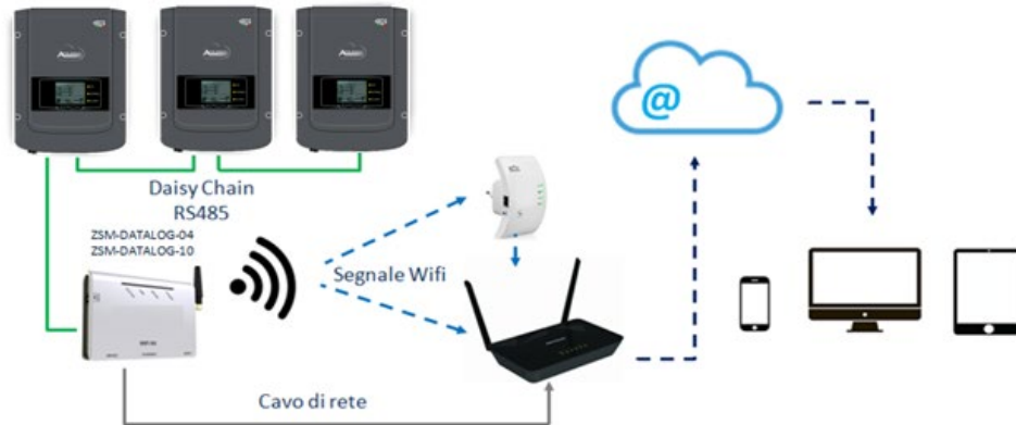
Abbildung 153 – Verbindungsschema des Datenloggers ZSM-DATALOG-04 / ZSM-DATALOG-10
