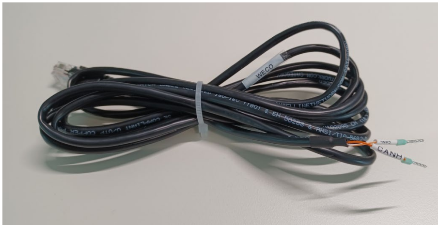
Abbildung 55 - Kommunikationskabel zwischen dem Inverter und der WeCo-Batterie 5K3XP
