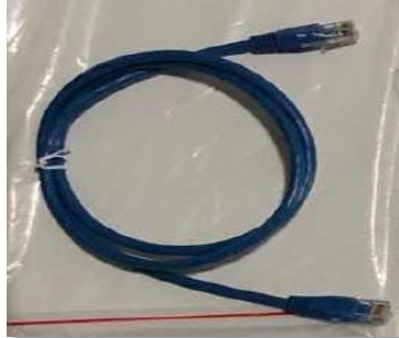
Abbildung 71 – Kommunikationskabel zwischen Batterien AZZURRO 5000
