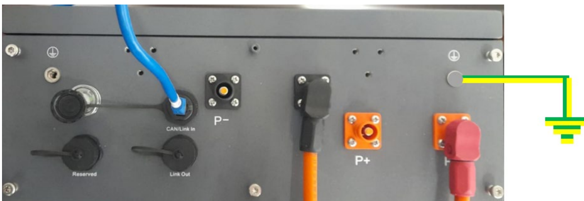
Abbildung 94 – Klemmenleiste der Batterie AZZURRO 5000 PRO
