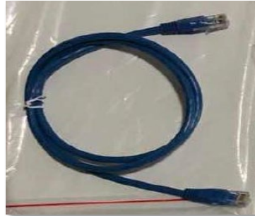
Abbildung 50 – Kommunikationskabel zwischen-Batterien WeCo 5K3
