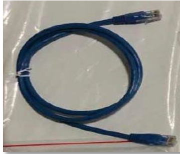
Figure 50 – Câble de communication entre batteries WeCo 5k3
