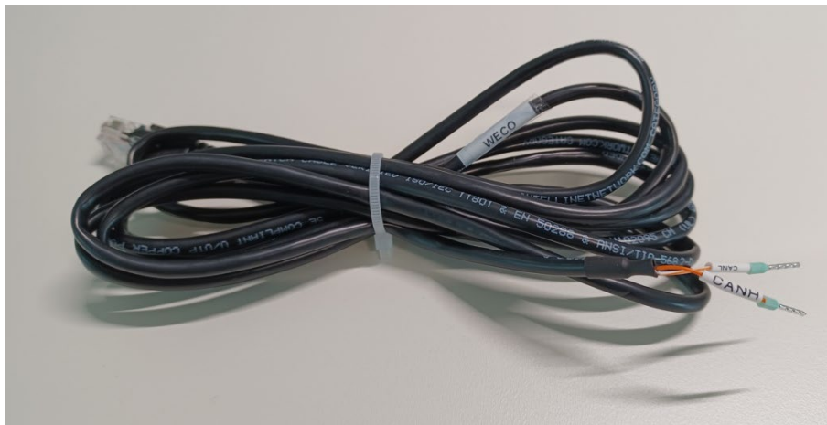
Figure 48 - Câble de communication entre l'onduleur et la batterie WeCo 5k3
