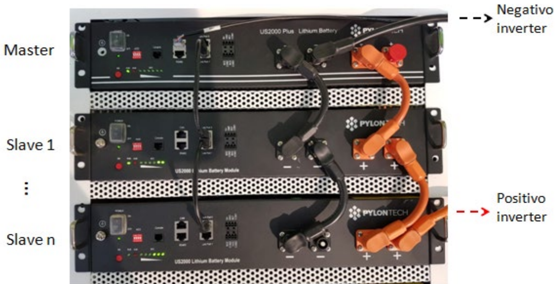
Figure 17 – Connexion de trois batteries Pylontech en parallèle
