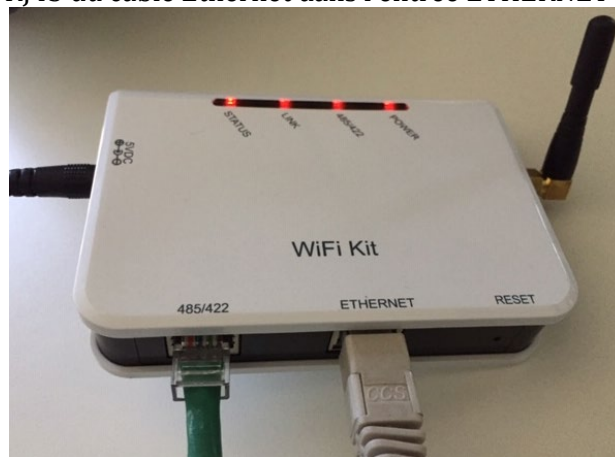
Figure 162 – Câble Ethernet connecté au datalogger
