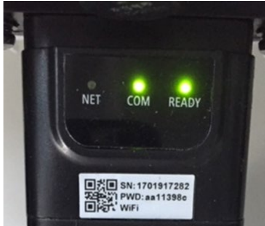
Figure 145 – État de communication irrégulière entre carte et serveur à distance
