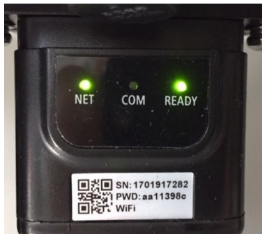
Figure 144 – État de communication irrégulière entre onduleur et carte
