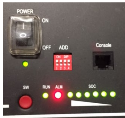
Figure 111 – État de la batterie après avoir positionné l'interrupteur POWER sur ON et appuyé sur le bouton SW
