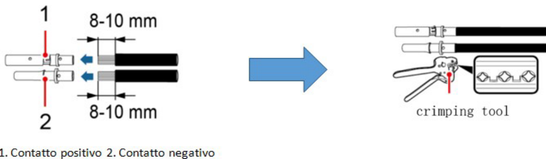
Figure 9 – Préparation des câbles photovoltaïques positif et négatif
