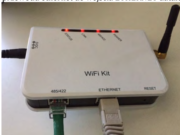
Rysunek 163 - Przewód ethernet podłączony do rejestratora danych
