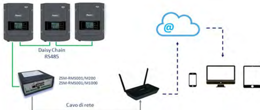
Rysunek 154 - Schemat funkcjonalny rejestratora danych ZSM-RMS001/M200 / ZSM-RMS001/M1000
