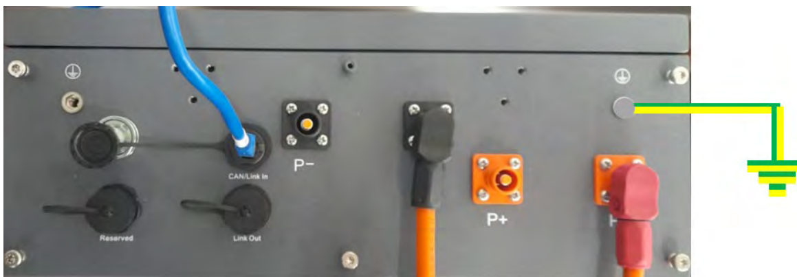
Rysunek 94 – Podłączenie baterii AZZURRO 5000 S
