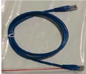
Rysunek 57 – Przewód komunikacyjny pomiędzy bateriami WeCo 5K3XP
