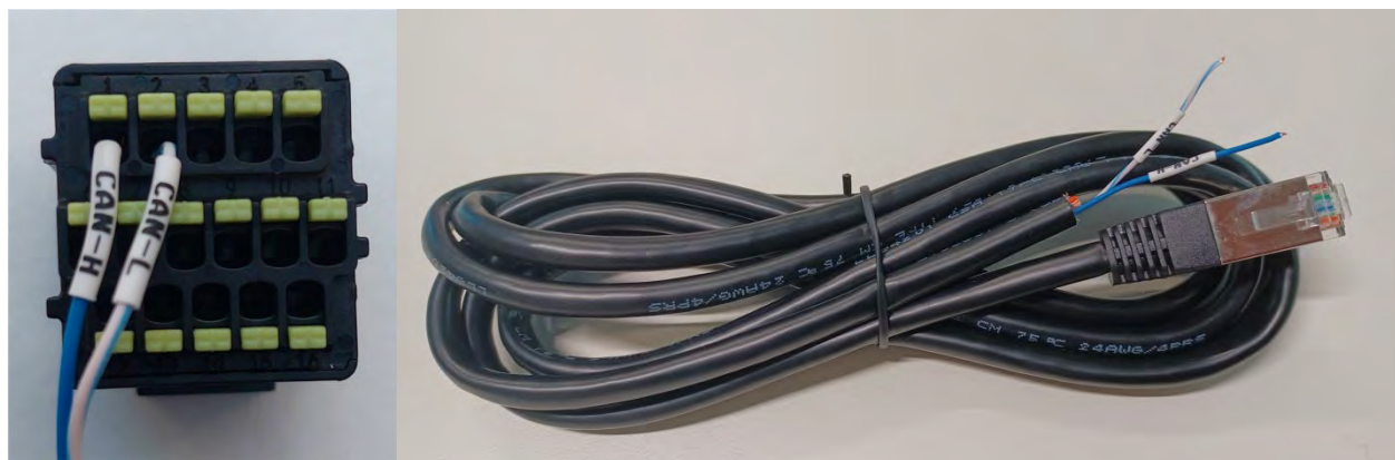
Rysunek 75 - Przewód komunikacyjny pomiędzy falownikiem i baterią AZZURRO 5000 PRO
