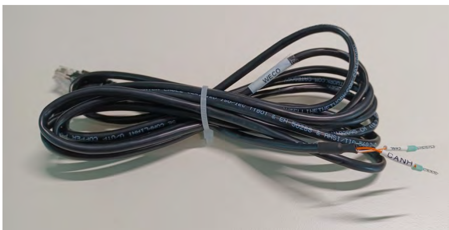
Rysunek 48 - Przewód komunikacyjny pomiędzy falownikiem i baterią WeCo 5k3
