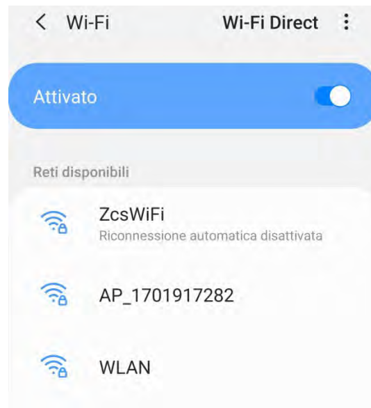
Rysunek 165 - Wyłączenie automatycznego ponownego podłączenia do sieci
