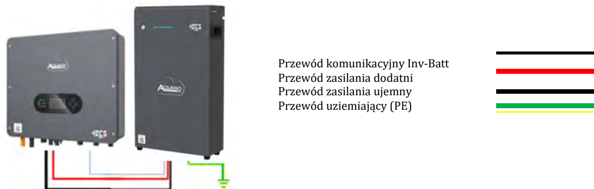
Rysunek 93 – Podłączenie baterii AZZURRO 5000 PRO
