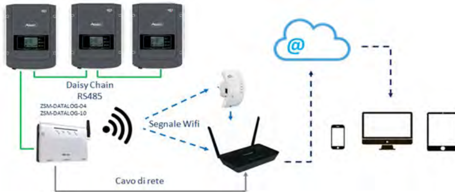
Rysunek 153 – Schemat podłączenia rejestratora danych ZSM-DATALOG-04 / ZSM-DATALOG-10
