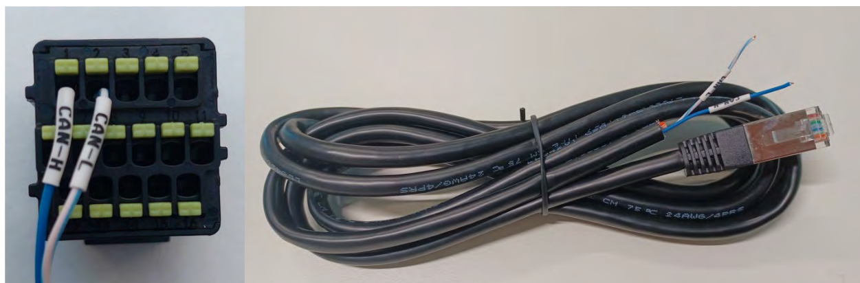
Rysunek 92 - Przewód komunikacyjny pomiędzy falownikiem i baterią AZZURRO 5000 PRO
