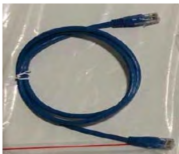
Rysunek 50 – Przewód komunikacyjny pomiędzy bateriami WeCo 5k3
