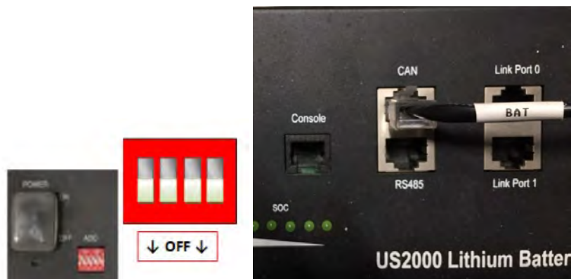
Rysunek 14- Podłączenie przewodu komunikacyjnego do baterii Pylontech
