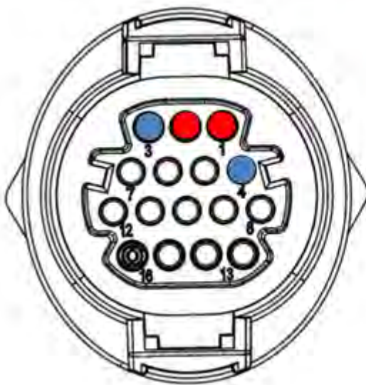
Rysunek 158 – Podłączenie linii szeregowej przez zacisk komunikacyjny 3PH HYD5000-HYD20000-ZSS
