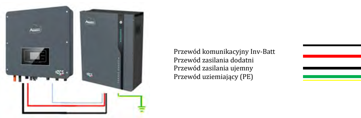
Rysunek 68 - Podłączenie baterii AZZURRO 5000
