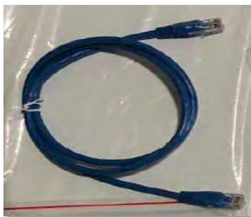
Rysunek 87 - Przewód komunikacyjny pomiędzy bateriami AZZURRO ZSX 5120
