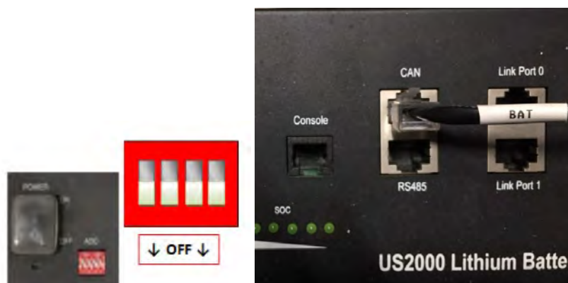
Rysunek 19- Podłączenie przewodu komunikacyjnego do baterii Pylontech
