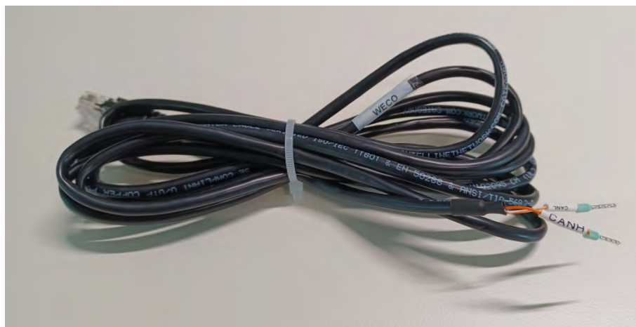
Rysunek 39 - Przewód komunikacyjny pomiędzy falownikiem i baterią WeCo 4k4 LT
