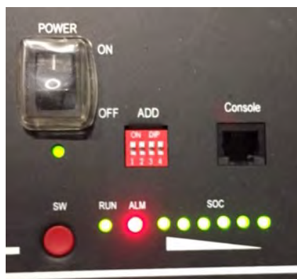
Rysunek 112 – Stan baterii po ustawieniu przełącznika POWER w pozycji ON i naciśnięciu przycisku SW
