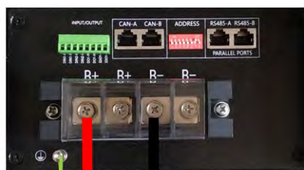
Rysunek 40 – Podłączenie baterii WeCo 4k4 LT
