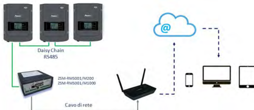
Рисунок 73 – Схема функціонування реєстратора даних ZSM-RMS001/M200 / ZSM-RMS001/M1000
