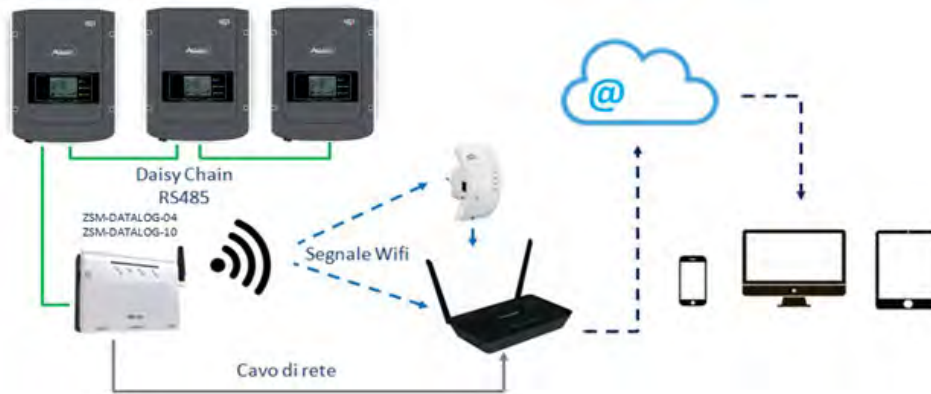
Рисунок 72 – Схема підключення реєстратора даних ZSM-DATALOG-04 / ZSM-DATALOG-10
