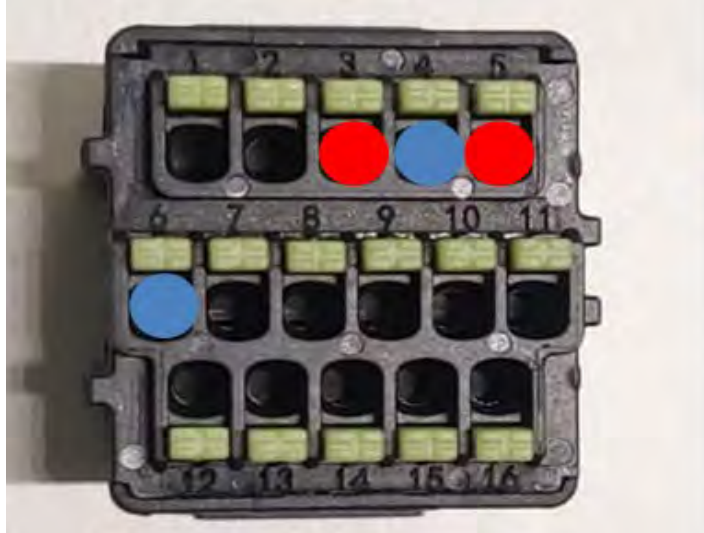
Рисунок 79 – Підключення послідовної лінії через роз'єм зв'язку для 1PH HYD3000-HYD6000-HP
