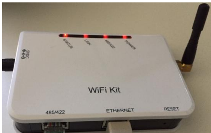
Рис. 105- Світлодіоди, які вказують на правильну конфігурацію реєстратора даних
