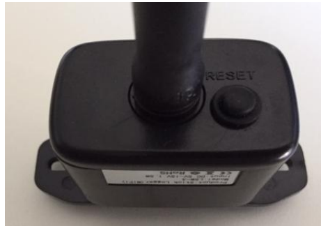
Рисунок 54 - Кнопка скидання налаштувань на платі Wi-Fi
