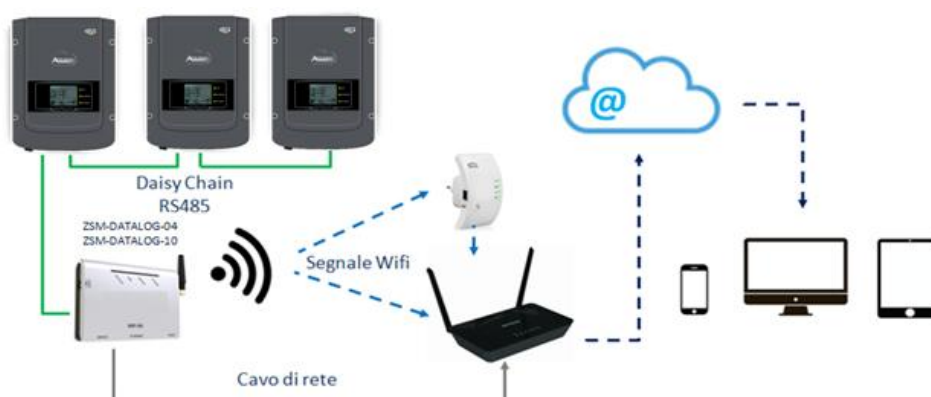
Рисунок 74 - Схема підключення реєстратора даних ZSM-DATALOG-04 / ZSM-DATALOG-10
