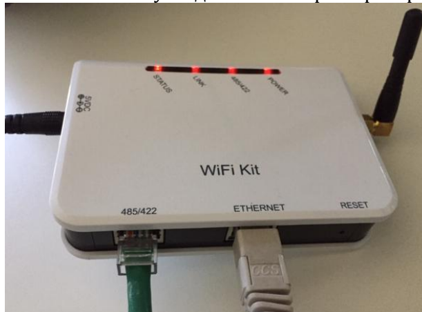
Рис. 82– Кабель Ethernet, підключений до реєстратора даних
