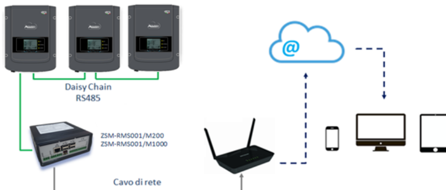
Рисунок 75 - Схема функціонування реєстратора даних ZSM-RMS001 / M200 / ZSM-RMS001 / M1000
