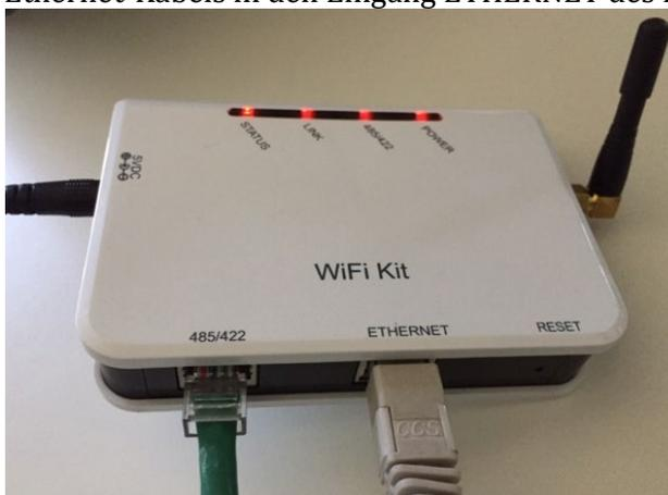
Abbildung 89 – An den Datenlogger angeschlossenes Ethernet-Kabel
