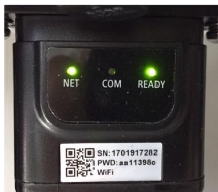
Abbildung 79 - Unregelmäßiger Kommunikationsstatus zwischen Inverter und Adapter
