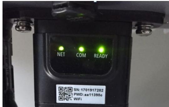
Abbildung 78 - Endstatus der LEDs
