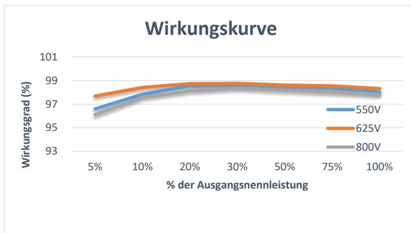
Abbildung 10 – Wirkungskurve der Leistung (z.B. 80 kW)
