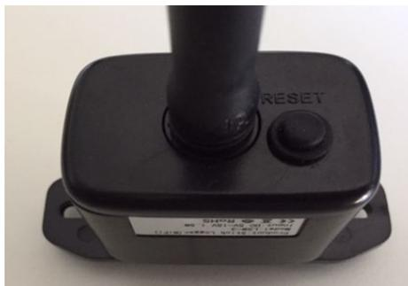
Abbildung 61 – Schaltfläche Reset auf dem WLAN-Adapter
