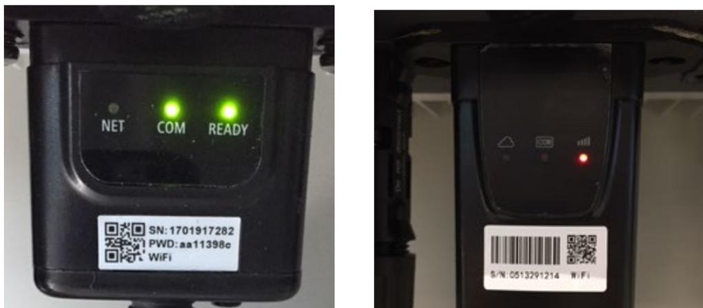
Abbildung 64- Unregelmäßiger Kommunikationsstatus zwischen WLAN und Remote Server
