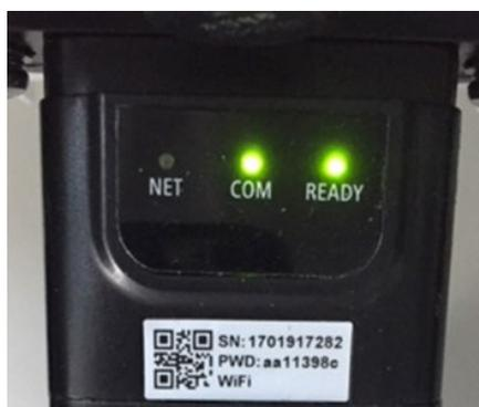
Abbildung 80 - Unregelmäßiger Kommunikationsstatus zwischen dem Adapter und dem Remote Server
