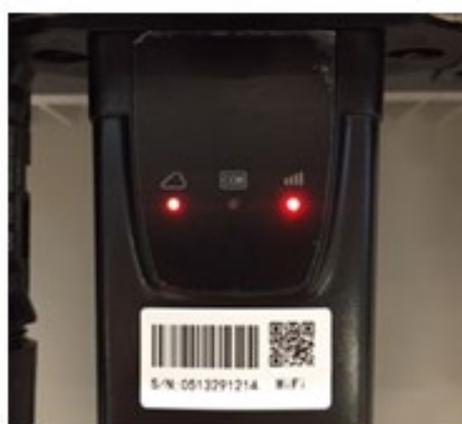
Abbildung 62 - Status unregelmäßige Kommunikation zwischen Inverter und WLAN
