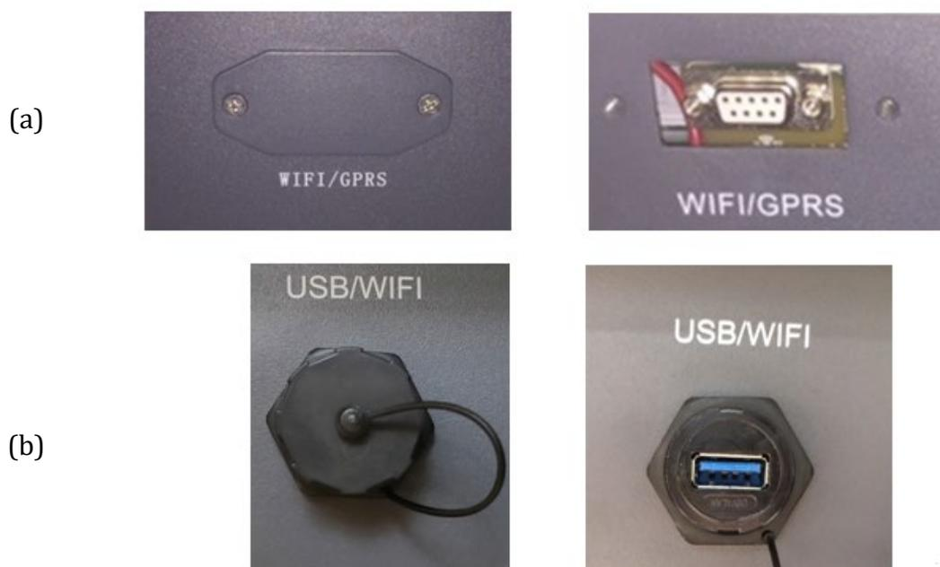
Abbildung 42 – Steckplatz für den externen WLAN-Adapter
