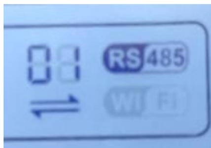
Abbildung 88 – RS485-Symbol auf dem Display des Inverters
