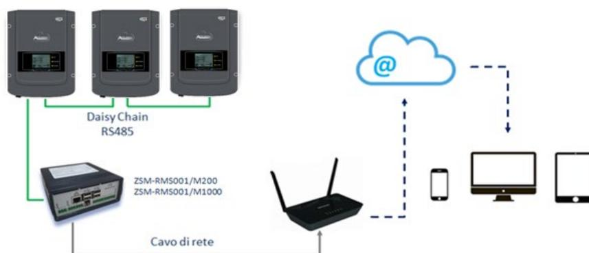
Abbildung 82 – Schema des Betriebs des Datenloggers ZSM-RMS001/M200 / ZSM-RMS001/M1000
