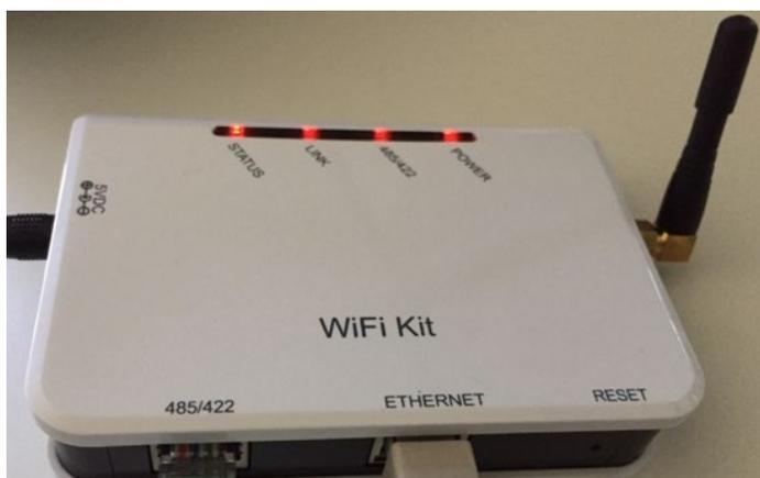
Abbildung 102 – LED, das die korrekte Konfiguration des Datenloggers anzeigt
