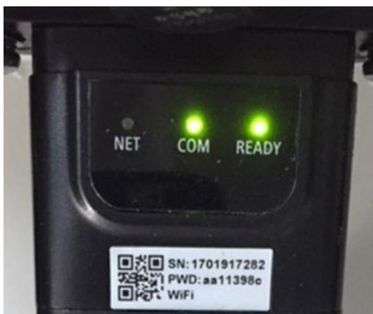
Abbildung 74 - Unregelmäßiger Kommunikationsstatus zwischen dem Adapter und dem Remote Server
