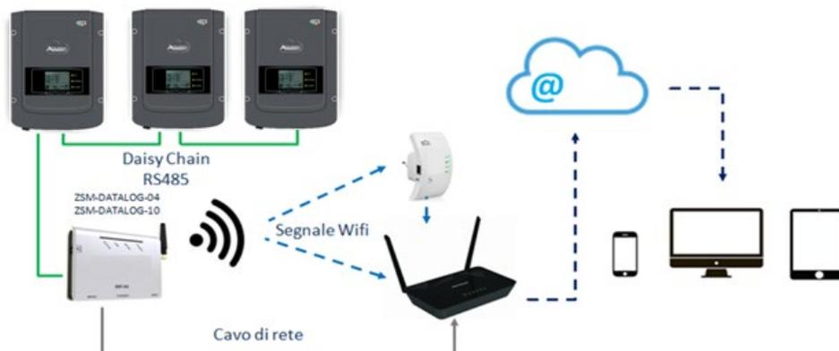
Abbildung 81 – Verbindungsschema des Datenloggers ZSM-DATALOG-04 / ZSM-DATALOG-10
