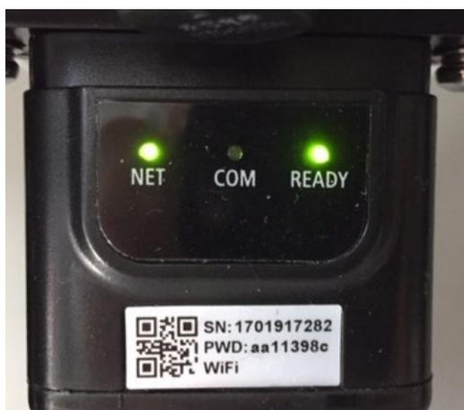
Abbildung 73 - Unregelmäßiger Kommunikationsstatus zwischen dem Inverter und dem Adapter
