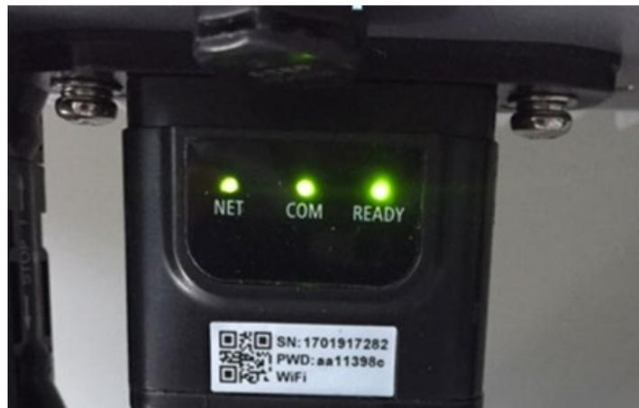
Abbildung 72 - Endstatus der LEDs
