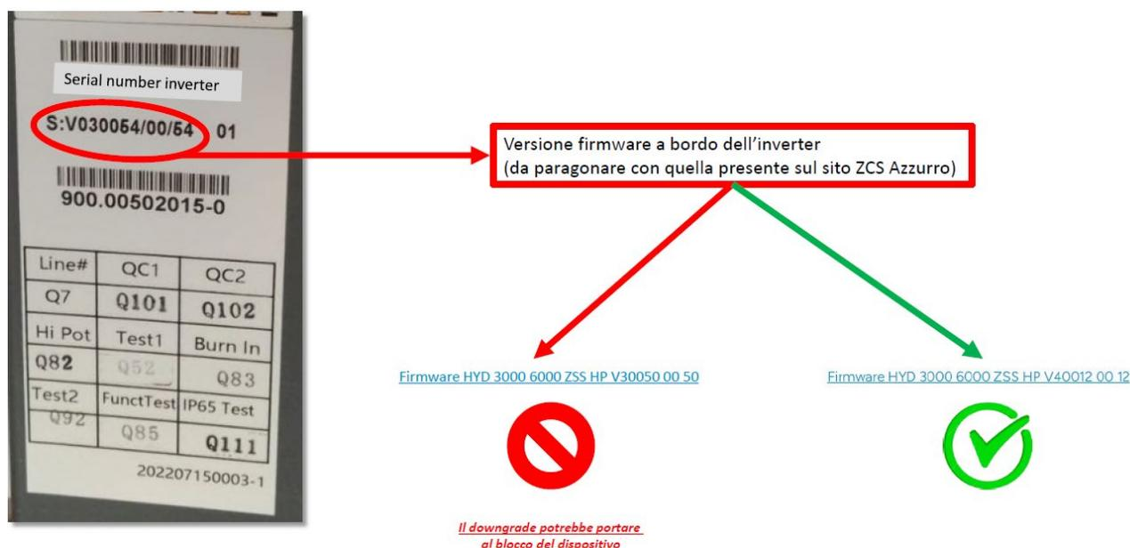
**AUFMERKSAMKEIT!! Ein Downgrade der Firmware-Version des Wechselrichters kann zu Gerätefehlern führen.**
