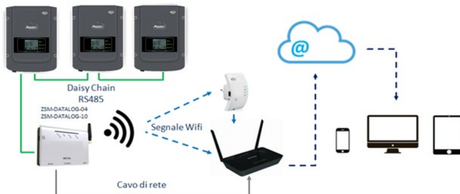
Figura 81 - Esquema ara la conexión de los datalogger ZSM-DATALOG-04/ZSM-DATALOG-10
