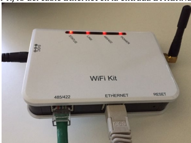
Figura 89– Cable Ethernet conectado al datalogger
