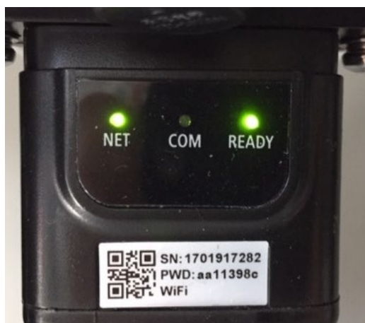
Figura 73 - Estado de comunicación irregular entre el inversor y el adaptador
