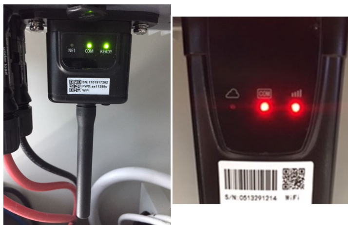
Figura 59 - Estado inicial de los LED
