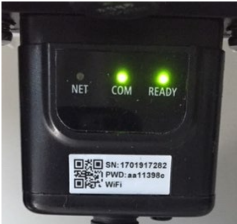
Abbildung 235 – Unregelmäßiger Kommunikationsstatus zwischen WLAN und Remote Server
