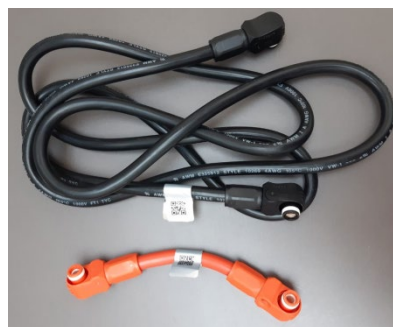
Abbildung 43 - Anschlusskabel zwischen BMS und Batteriemodulen
