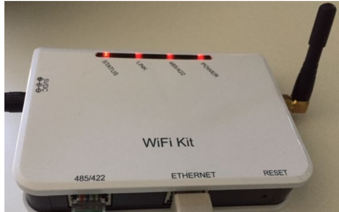
Abbildung 275 – Led, welche die korrekte Konfiguration des Datenloggers anzeigen
