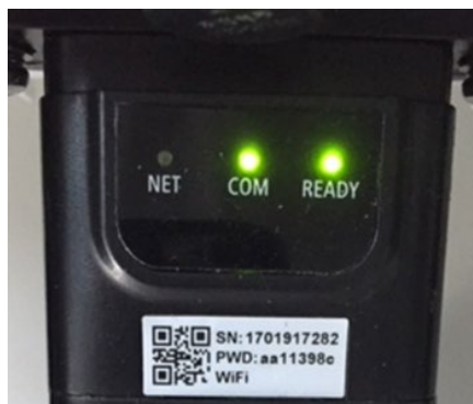
Abbildung 251 – Unregelmäßiger Kommunikationsstatus zwischen Platine und Remote Server
