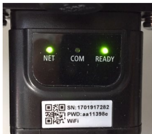
Abbildung 244 - Unregelmäßiger Kommunikationsstatus zwischen Inverter und Platine
