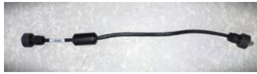
Figura 134 – Cable de comunicación entre BDU1 y BDU2
