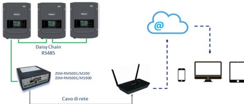
Figura 253 – Esquema de funcionamiento del Datalogger ZSM-RMS001/M200 / ZSM-RMS001/M1000
