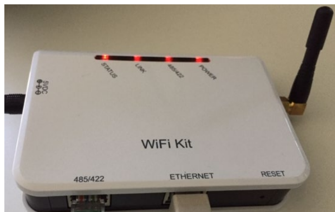
Figura 275 – Led que indican que el datalogger está correctamente configurado
