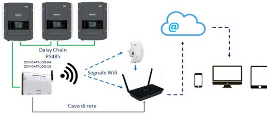
Figura 252 – Esquema de conexión del datalogger ZSM-DATALOG-04 / ZSM-DATALOG-10
