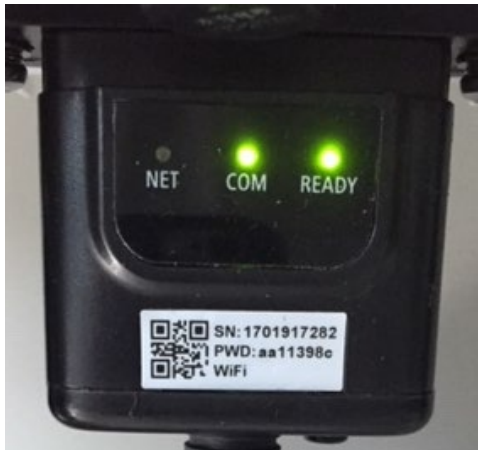
Figura 235 – Estado de comunicación irregular entre wifi y servidor remoto
