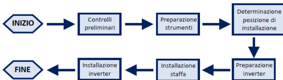
Figura 3 - Proceso de instalación
