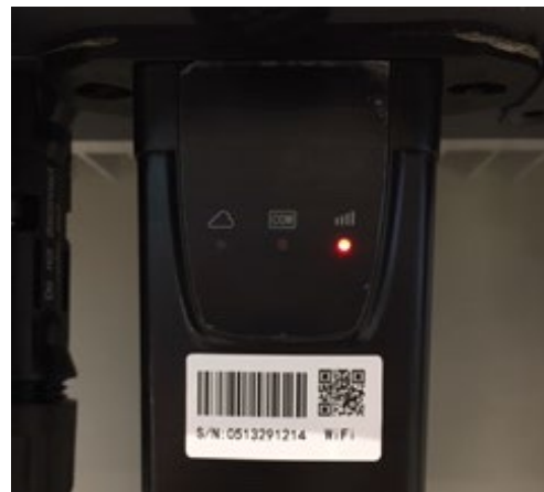
Figura 235 – Estado de comunicación irregular entre wifi y servidor remoto
