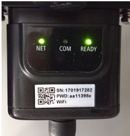
Figura 233 - Estado de comunicación irregular entre inversor y wifi
