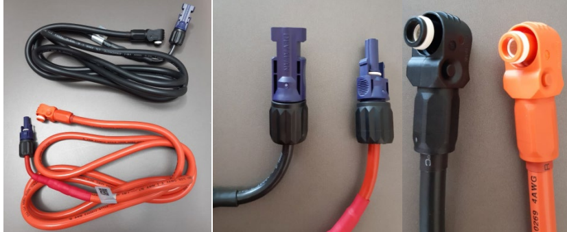
Figura 46 - Cables de potencia BMS Inversor (a la izquierda), terminales de potencia lado inversor (en el centro), terminales de potencia lado batería (a la derecha)
