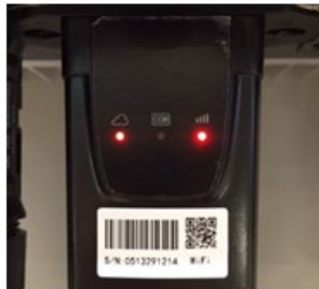
Figura 233 - Estado de comunicación irregular entre inversor y wifi
