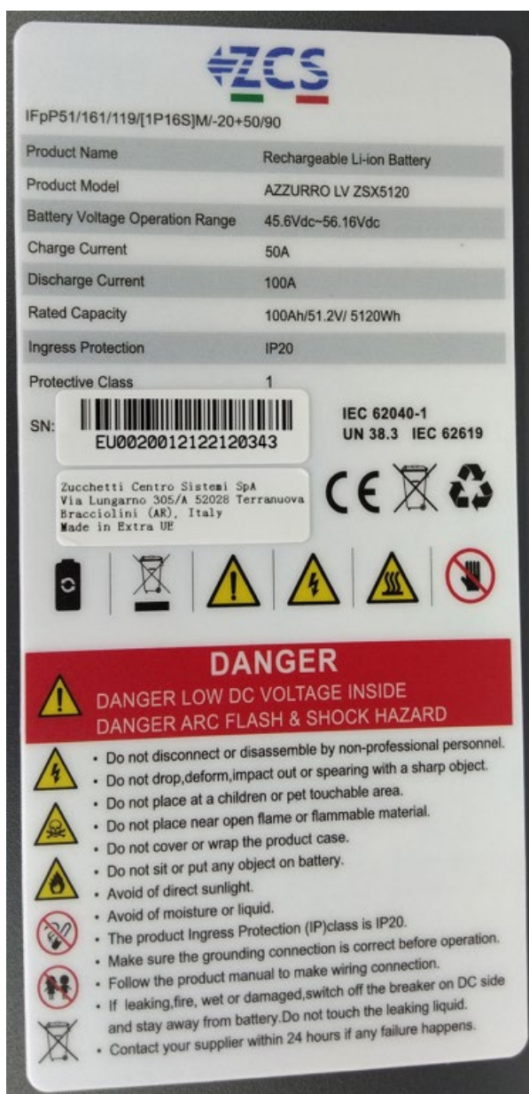
Рисунок 1 - Наклейки збоку від акумуляторної батареї
