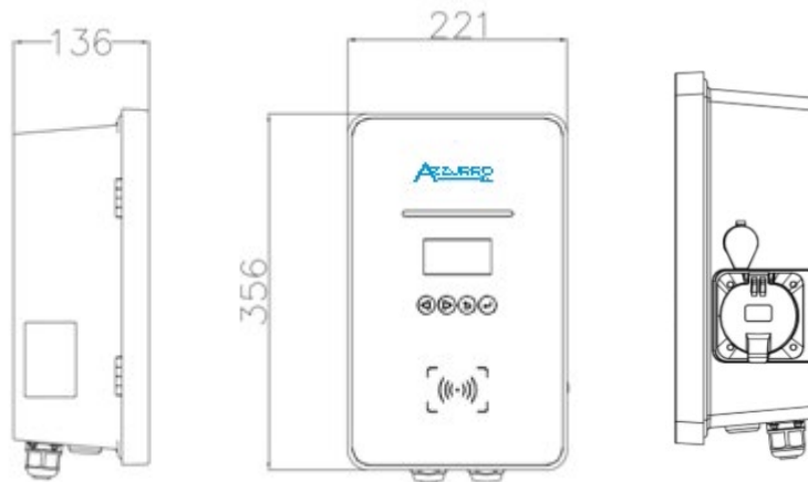
Figura 4 - Vista frontal y lateral de la estación de recarga
