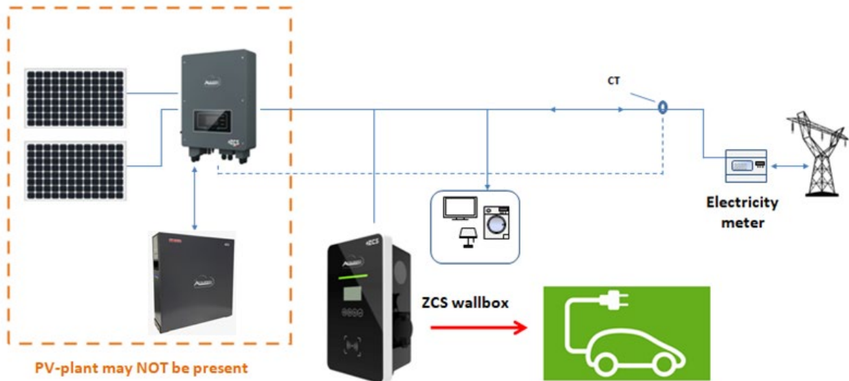
Рис. 3 – Приклад станції зарядки у виробничих умовах, підключеної до фотоелектричного елемента (необов'язково) та мережі
