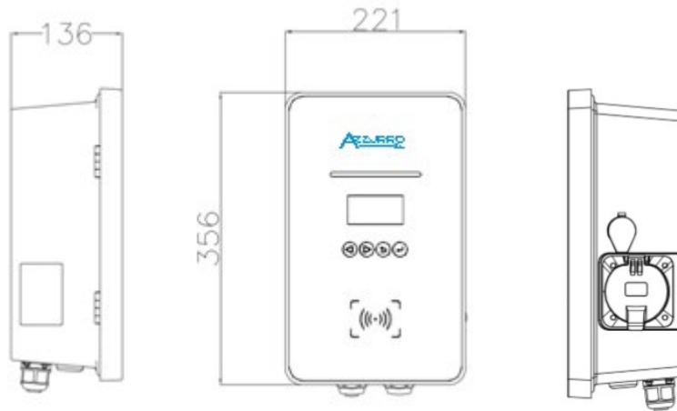
Рис. 4 – Вид спереду, збоку станції зарядки
